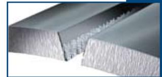
Saldatura di un nastro sezionato longitudinalmente ad un tubo previa bordatura del nastro.
